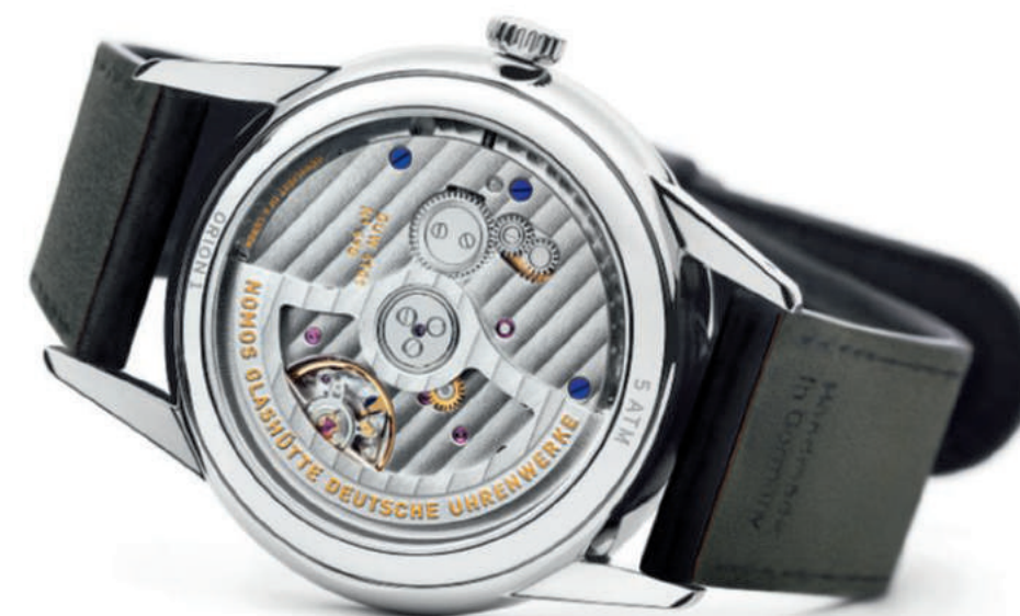
Il calibro DUW 6101 è un movimento meccanico a carica automatica di Manifattura Nomos con 42 ore di riserva di marcia. Diametro di 35,2mm e spessore di 3,6mm. Il movimento è dotato dello scappamento Swing-System, brevetto Nomos, riconoscibile dalla caratteristica spirale del bilanciante blu temperato. Il rotore con caratteri in rilievo placcati oro porta l'incisione "reguliert in 6 Lagen" (regolato in 6 posizioni) sul lato inferiore.
