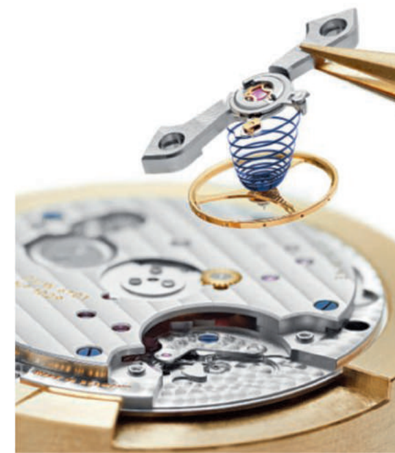
Il calibro DUW 6101 è un movimento meccanico a carica automatica di Manifattura Nomos con 42 ore di riserva di marcia. Diametro di 35,2mm e spessore di 3,6mm. Il movimento è dotato dello scappamento Swing-System, brevetto Nomos, riconoscibile dalla caratteristica spirale del bilanciante blu temperato. Il rotore con caratteri in rilievo placcati oro porta l'incisione "reguliert in 6 Lagen" (regolato in 6 posizioni) sul lato inferiore.
